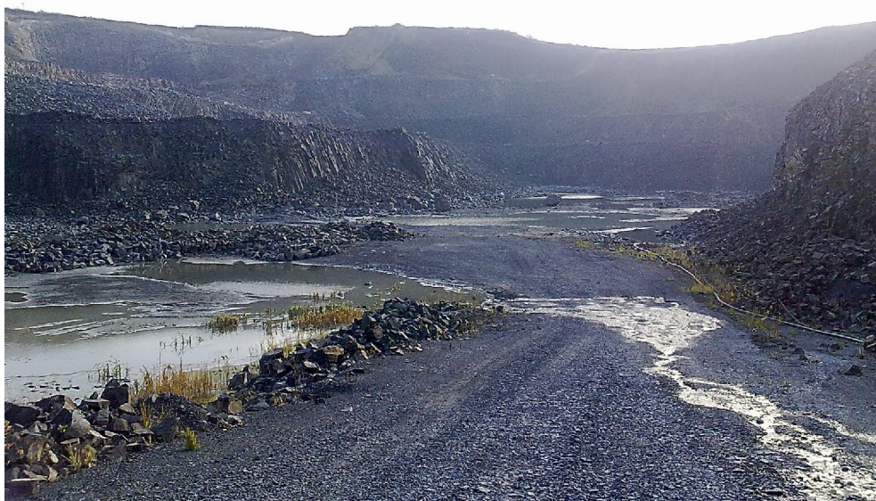
Foto č.34 - Stříbrník - únik důlní vody do dobývacího prostoru Autorské foto, listopad 2011
