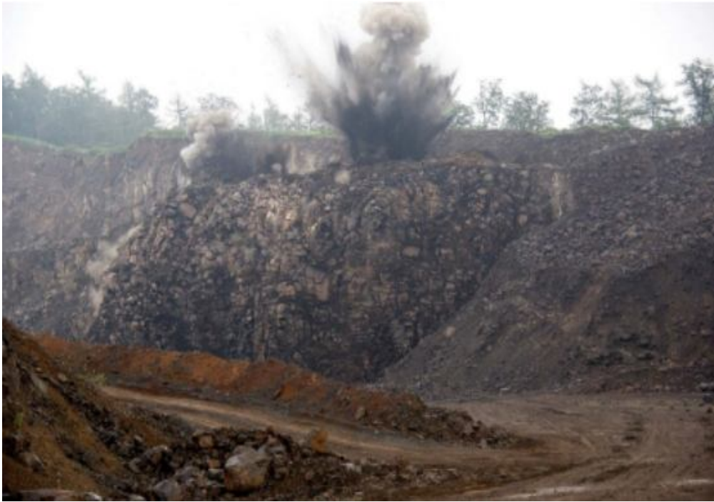
Foto č.13 - Trabice - průběh clonového odstřelu jižní lomové stěny ve východní polovině třetí etáže - výbuch (bibliografický zdroj č.6)
