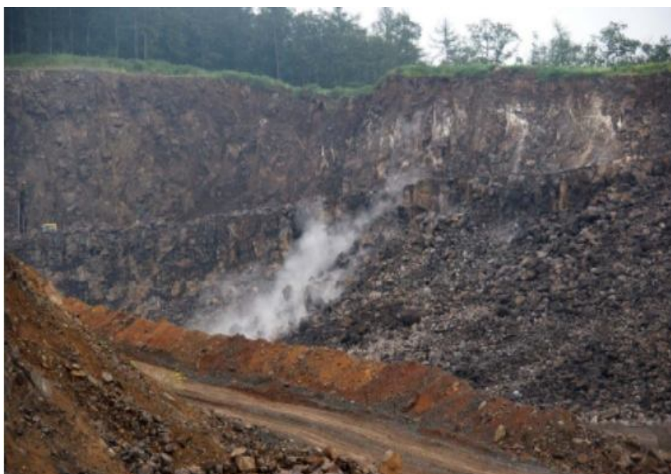
Foto č.16 - Trabice - průběh clonového odstřelu jižní lomové stěny ve východní polovině třetí etáže - závěrečná fáze (bibliografický zdroj č.6)
